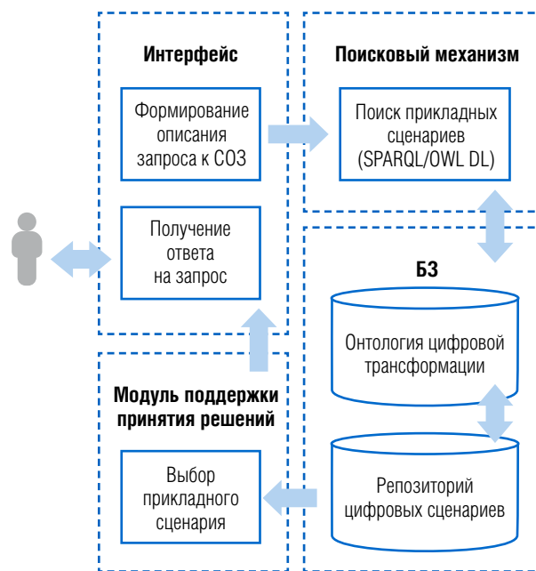
Рис. 1. Взаимодействие пользователя и системы, основанной на знаниях, для обоснования варианта цифровой трансформации предприятия.
